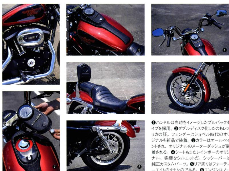
①ハンドルは当時をイメージしたブルバックタイプを採用。②ダブルディスク化したのもレプリカの証。フェンダーはショベル時代のオリジナルを新品で装着。③カラーはオールペイントされ、オリジナルのメーターダッシュが装着される。④シートもまたレインボーのオリジナル。完璧なシルエットだ。シッパーは純正カスタムパーツ。⑤リア周りはフォーティエイトのままなのである。⑥エンジンはノーマル。エアクリーナーの形状が当時のビッグツインモデルに似ているのだ。⑦メーターダッシュの内側にタンクキャップ。
