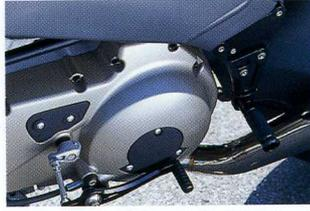
ステップはベースプレートごと交換するハイサイド製。主張させることなくブラックアルマイトを施し、フレームに溶け込ませる
