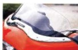
低めの純正ウインド・シールドを取り付けて、さらにクロムのトリムを追加
