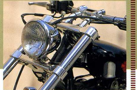
ヘッドライトはアレン・ネス製の5-3/4インチタイプを選択。低めに設定されたライザー&ドラッグバーとともに、引き締まったフロント周りを演出している
