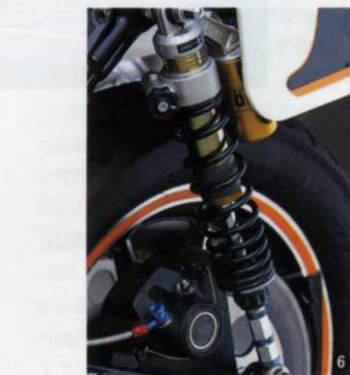
⑤レースを始めた当時はスーパートラップのエキパイにスリップオンのマフラーを装着していたが、その後ワンオフとなり、今ではご覧のレインボー製となっている⑥オーリンズのショックにはオリジナルの車高調整アダプターが装着される⑦操作性抜群のステップ類はモトラライフ製である
