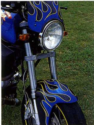
フロントフォークはX1のものを装着。走りの質を向上させている
