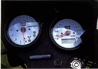
M2のメーターを取り払って、S1から移植されたメーターキット。ホワイト地のタコとスピードメーターがレーシングイメージを高める
