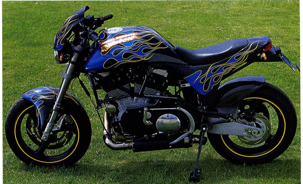
M2をベースにメーター、カウル、シートなどをS1から、リヤフェンダー、フェンダーレスキット、ベルトカバー、フロントフェンダーなどが、レインボーオリジナルのパーツで構成される。フレアーを描いたカラーリングも見事にイメージにマッチングしている
