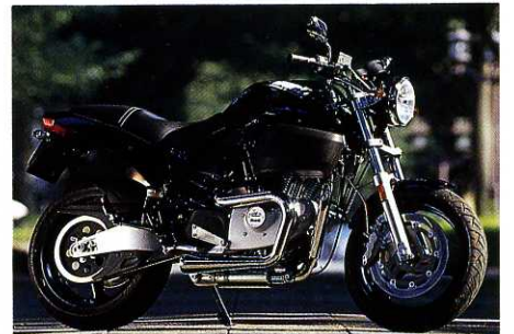
ウインドシールドを取り外して軽快なイメージ。違和感のないようにヘッドライトは上方に持ち上げられている
