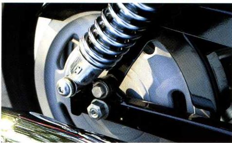
足付きを少しでもよくするために装着したギジマのロワリングキット。30mm車高が下がるリアショックのマウント位置を後ろにずらす→ショックが寝る→車高が下がるというわけだ。
