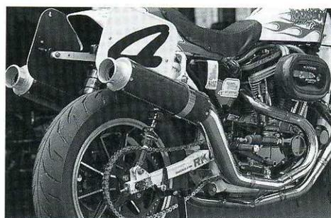
ド迫力の2本出しマフラー。排気効率の向上と、バンク角を稼ぐためのデザインは、まさにレース用。この車両のようにサスを長くしていないと、スタンダードでは装着できなそう。
